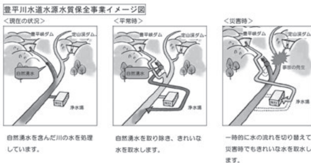
図5 札幌市が計画している、豊平川水道水源水質保全事業(総事業費187億円)(札幌市水道事業5年計画(2010-2014)資料より) 定山溪温泉付近のヒ素を含む自然湧水を迂回させるための送水管を建設して、その水を白川浄水場下流に放流する。豊平川に事故がある場合には、この送水管を利用して豊平峡ダムの水を白川浄水場に流す。
