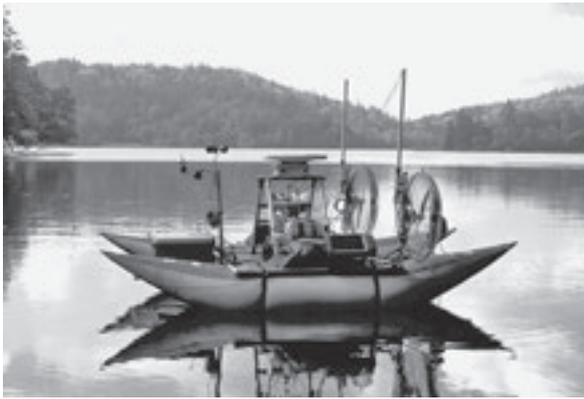
図10 魚探の調査に使用したロボットボート。ボートは東京大学海津裕准教授より借用。
