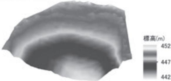
図5 魚探で得た水深から作成した湖底の地形図。チュウルイ湾内の線は球状マリモ群生域を示す。標高は楕円体高(地球を楕円体と仮定した面からの高さ)である。調査時(2011年9月)の湖水面の楕円体高は約453 m。
